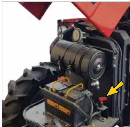
شکل ۴۳: کلید قطع کن باتری
