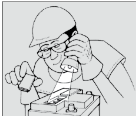
شکل ۵۸: کنترل سطح آب باتری
