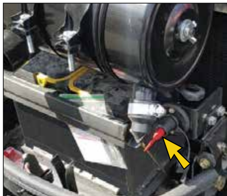
شکل ۶۰: کلید قطع کن باتری
