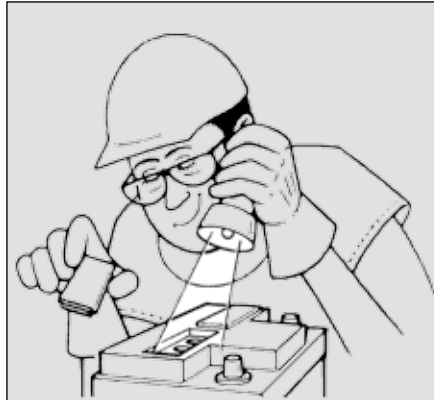
شکل ۱۲: کنترل سطح آب باتری
